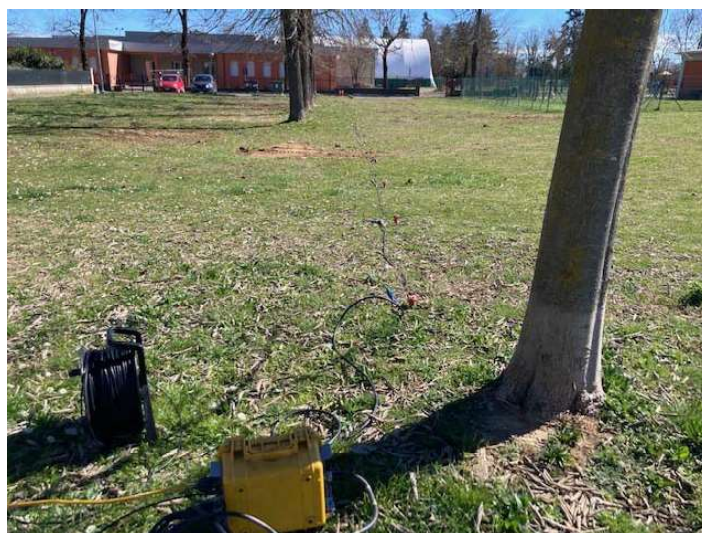
Figura 3 - - Foto punto di esecuzione prospezione geofisica MASW.
