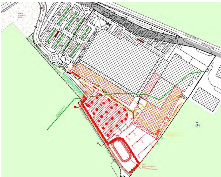
Figura 4. Planimetria stato di fatto con sovrapposizione stato di progetto (in rosso gli edifici e pertinenze in progetto).
